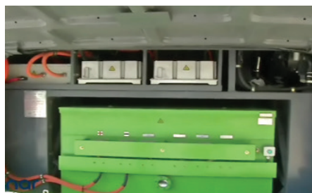
Фиг.1. Супер-кондензаторен модул Aowei за транспортни приложения с капацитет 780 F, със самостоятелно следене параметрите на всяка клетка [3]
