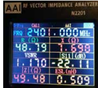
Fig. 7. Electrical parameters of antenna 4 X 4 „Yagi“
