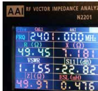
Fig. 8. Electrical parameters of antenna 4 X 1 „Helical“
