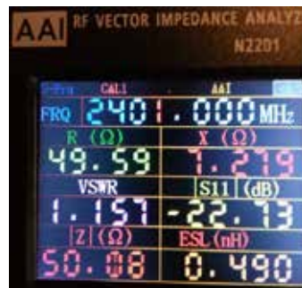
Fig. 9. Electrical parameters of antenna „Helical“
