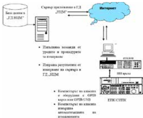
Фиг.2 Дистанционно калибриране на еталони и средства за измерване на електрична мощност и енергия в ГД „НЦМ“
