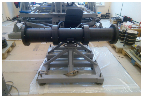
Фиг. 2 – Балансировка эталона на ножевых опорах
