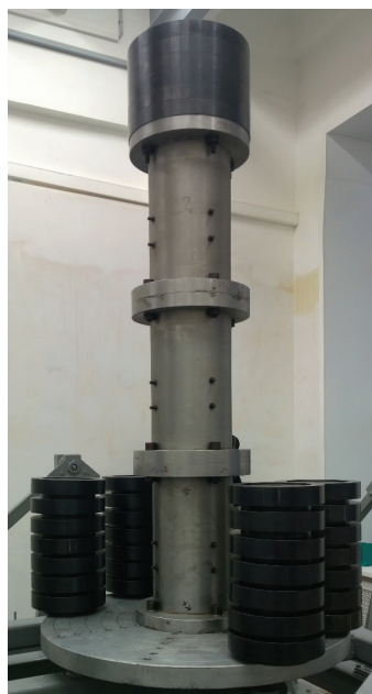
Фиг. 1 - Специальный эталон единицы массы, единицы длины в области измерений координат центра масс и единицы момента инерции
